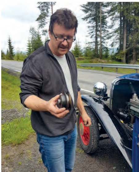
I skogane på Toten knakk splinten til vasspumpa. Jan Kokkersvold studerer restane.
